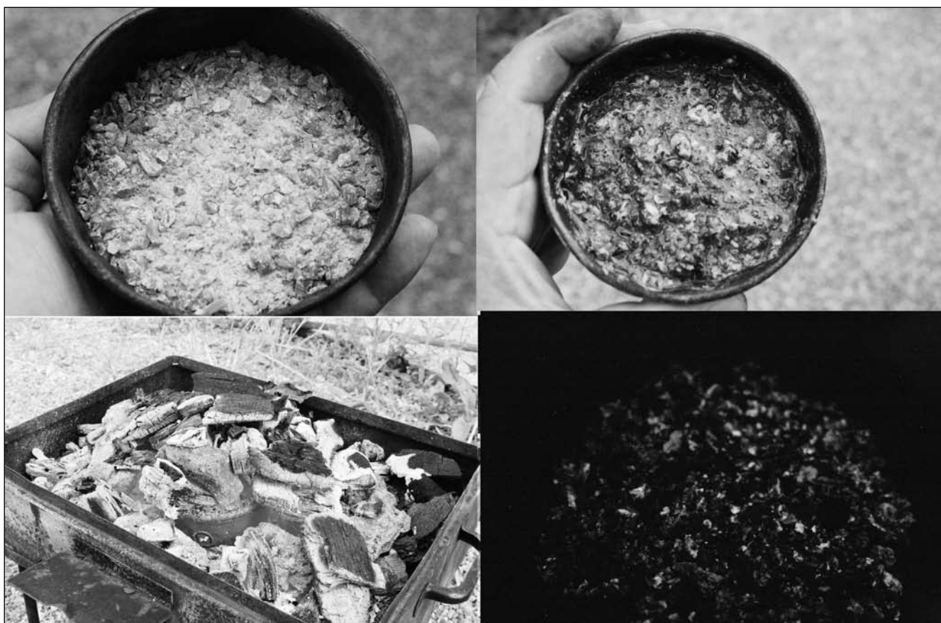
Fig. 4. Fasi della calcinazione della barite.
